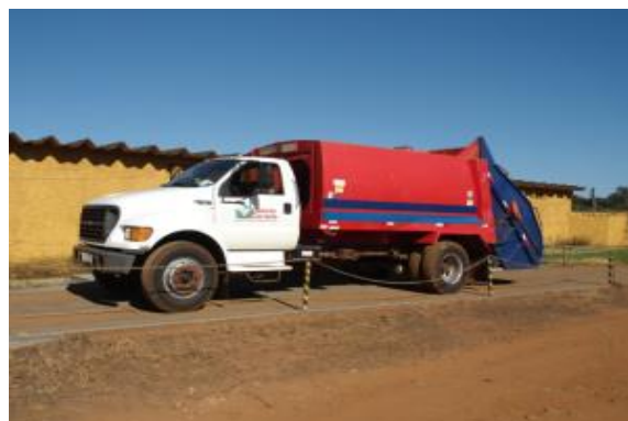
Foto 8: Caminhão caçamba compactadora sendo pesado no local.
